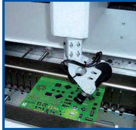
*Die Rotationsachse ermöglicht Bauteilansichten aus verschiedenen Kamerapositionen*
